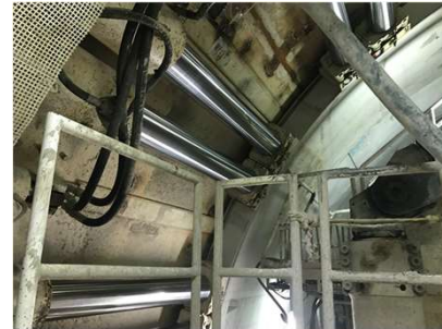
Escudo simple. Mecanismo de reacción (Fuente herrenknecht.com)
